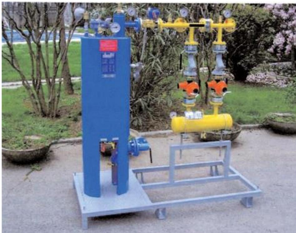
Esempio di gruppo di riduzione di 1° stadio collegato a valle di un vaporizzatore.
